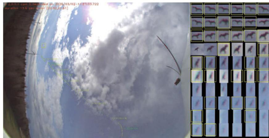
Vögel im Anflug erkennen: Das intelligente Kamerasystem „BirdVision“ wird an Windkraftanlagen der Stadtwerke getestet und schaltet bei Gefahr die Rotoren ab.
